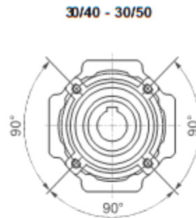
4 Fori / Holes / Bohrungen
